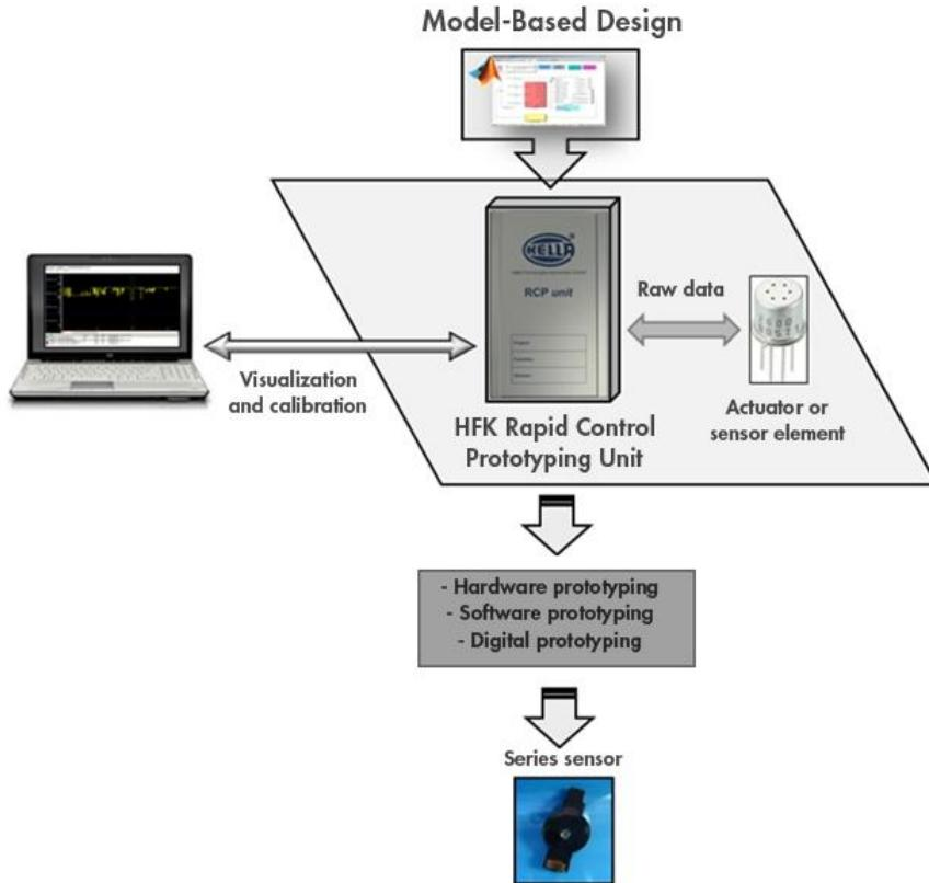
圖 2. 運用 HFK RCP 單元以及模型化基礎設計的 Hella 工作流程
